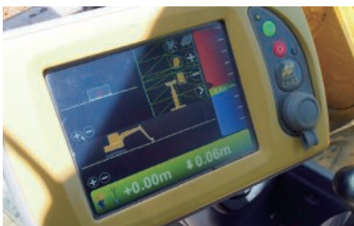
重機のコントロールパネル
