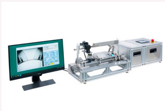
湾曲形状解析機能搭載 クラムシェル型屈曲試験機 （フレキシブルデバイス耐久試験装置）
